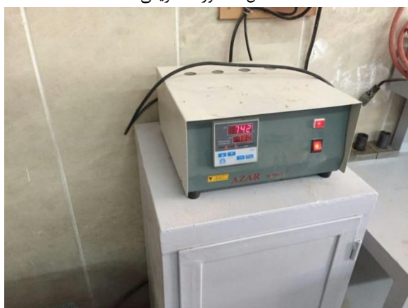
شکل ۴- نشانگر دمای کوره الکتریکی
