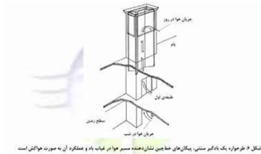
شکل ۱۴ طرح واره یک بادگیر سنتی
